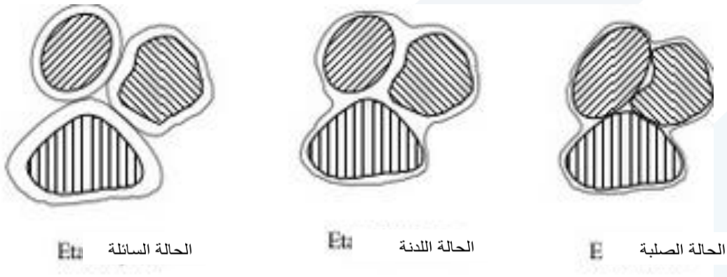
الشكل 2-4: المسافات بين جزيئات التربة الغضارية عند حالات قوام التربة المختلفة
